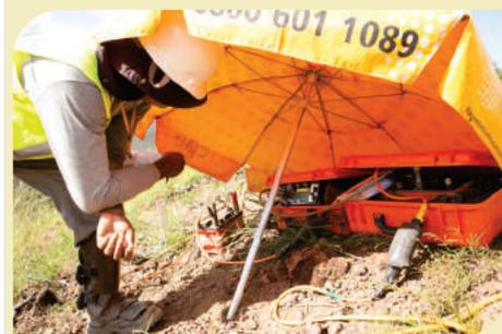
A Serra Verde investe em tecnologia rumo à exploração com as melhores práticas que viabilizarão as atividades da mineradora. Exemplo disso, é a utilização do método da eletrorresistividade. A pesquisa permite reduzir a quantidade de furos de sondagem na região mineralizada, diminuindo consideravelmente os custos e os impactos ambientais da pesquisa geológica
