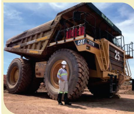
Veículos de 65 toneladas e com quase cinco metros de altura se destacam na frota em atividade na Mineração Serra Verde. Os Caminhões Fora-de-Estrada, modelo CAT-777D, capazes de carregar 100 toneladas, impressionam pela robustez diante dos demais veículos que circulam na obra e nas rodovias do país. **Pg.02**
