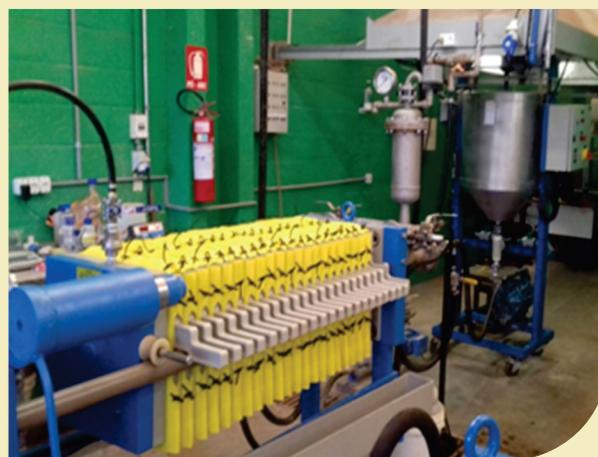
*Planta piloto do circuito de lixiviação e filtração do resíduo*
